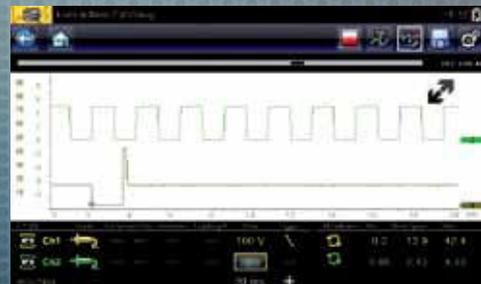
Grafisches 2-Kanal Digitalskop, digitales Multimeter und vorkonfigurierte Komponententests. Die geführten Prüfprozeduren beinhalten die automatische Signalsuche, Steckplatzbeschreibungen, sowie eine umfangreiche Datenbank mit Sollwerten und Gutbild-Darstellungen.
