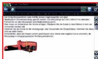
**Geführte Komponententests** inklusive automatischer Einstellungen, Anschlussanweisungen und Referenzwerten ermöglicht ein schnelles Vergleichen von Komponententests und verhindert somit den ungewollten Austausch von funktionsfähigen Bauteilen.
