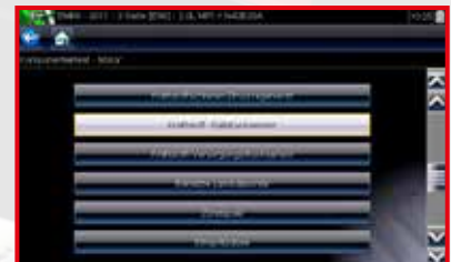
durch einen geführten Komponententest mit Messpunkten, Sollwerten und Gutbildern wird eine schnelle Fehlereingrenzung gewährleistet.
