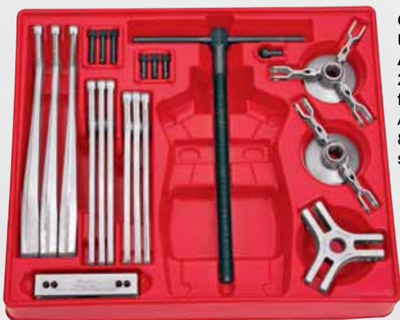
CG240B Universeller Abziehersatz, 2- und 3-armig. Mit Koterschlaggewicht für Innen- und Außenlager. Reichtiefe bis zu 63mm, Innen- durchmesser 9.53-31.75mm, Außendurchmesser bis zu 76mm. Ideal für Nadellager. Besteht aus Einzelabziehern CG240, CG243 und CJ93B.
