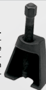
Lagertrenner. Ideal zum Trennen von bündig sit- zenden Lagern, um dann normale Abzieher oder Hebeleisen nutzen zu können. Zum Abziehen der La- gerinnenringe von Radlagern geeignet. Druck- schrauben optional erhältlich.
