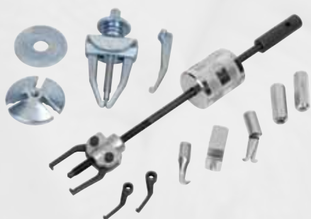
CG240B Universeller Abziehersatz, 2- und 3-armig. Mit Koterschlaggewicht für Innen- und Außenlager. Reichtiefe bis zu 63mm, Innen- durchmesser 9.53-31.75mm, Außendurchmesser bis zu 76mm. Ideal für Nadellager. Besteht aus Einzelabziehern CG240, CG243 und CJ93B.
