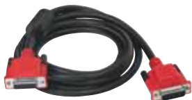
EAX0068L01A DA5 Adapterkabel Solus Ultra™. In Verwendung mit alten Kabeln und Adaptern.
