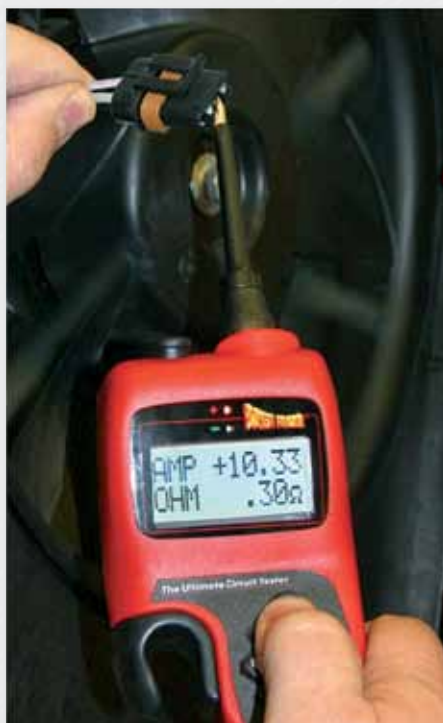
Aktiviert mit bis zu 100A Einschaltstrom und 25A kontinuierlich bis zur vollen Leistung.
