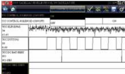
Bidirektionale Kontrollfunktionen während der Datenanzeige zur Diagnose von Ursache und Wirkung
