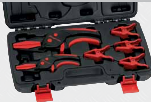
LCSS600 Schlauchklemmen- und Leitungsverschlusset. 6-teilig. Zum Abklemmen von Schläuchen und Abdichten von demontierten Stahlleitungen wie Kraftstoff-, Klima-, Servo-, Brems- und Ölkühlerleitungen etc. Dieses Set verhindert das Auslaufen von Flüssigkeiten bei diversen Servicearbeiten. Für alle gängigen Werkstattchemikalien geeignet. 2 Schlauchklemmenzangen von 3.175-19mm und 19-57.2mm.
