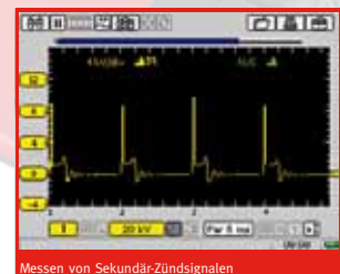
Messen von Sekundärzündsignalen
