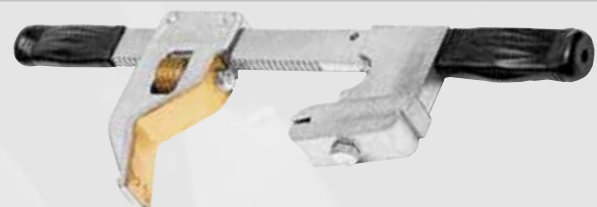
TR20M Gewindereparaturset für Außengewinde. Für Gewindebolzen mit \varnothing von 13-145mm sowie Rohrgewinde mit \varnothing von 6.35-100mm. 6 Metrische Gewindeplättchen mit Steigungen von 0.75 bis 5mm. Durch das Set ist ein "Aufrichten" eingedrückter Gewindegänge möglich.
