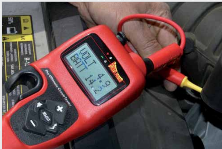
Zeigt Prüfspitzenspannung und Batteriespannung für einen leichten Vergleich an.
