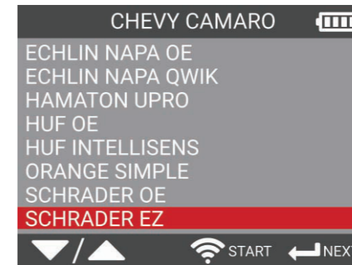
Möglichkeit der Programmierung von frei verfügbaren Universalsensoren
